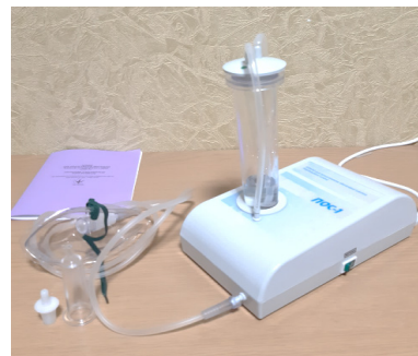
Рисунок 1 - Аппарат для приготовления пароводяной озонсодержащей смеси ПОС-1
