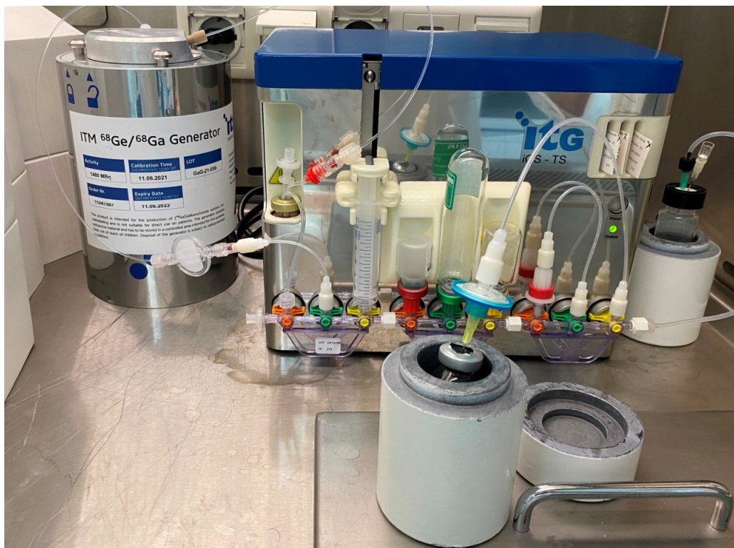
Рисунок 3. Автоматический синтез получения ^{68}\text{Ga} -PSMA-11 (ITG Isotope Technologies Garching GmbH, Garching, Germany).
